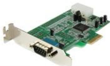
La carte série PCI Express PEX1S553LP vous permet de transformer un logement PCI Express en une connexion série RS232 (DB9).
