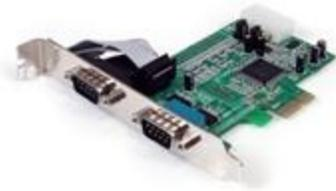
La carte série PCI Express PEX2S553 vous permet de transformer un logement PCI Express en deux ports série RS-232 (DB9). Basée sur une conception de puce unique native (pas de puce de pont), cette carte adaptateur série 2 ports vous permet d'exploiter la pleine capacité offerte par PCI Express (PCIe) et de réduire la charge appliquée à l'unité centrale de jusqu'à 48 %, par rapport aux cartes série conventionnelles.
