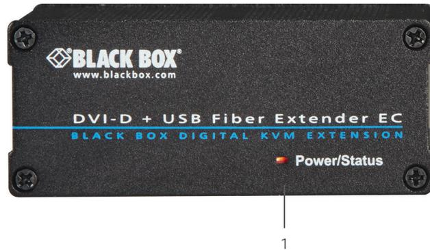
FIGURE 2-5. FRONT PANEL OF THE ACX310F-R2 LOCAL EXTENDER
