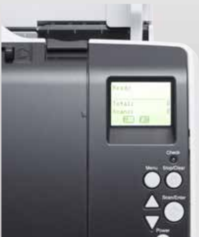
Geliştirilmiş arka ışıklı, entegre LCD çalışma paneli
