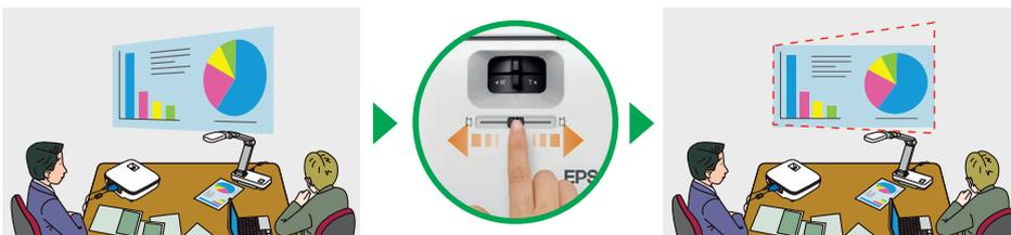
Dispositivo de ajuste de corrección Keystone horizontal: este nuevo e intuitivo control de deslizamiento te permite ajustar las imágenes a la forma correcta cuando el proyector se encuentra en ángulo con respecto a la pantalla.
