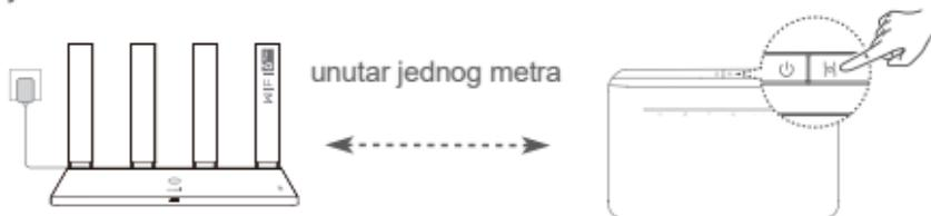
2. korak: kada pokazivač na uređaju HUAWEI CPE počne treperiti, pritisnite tipku H koja se nalazi na njemu. Pričekajte da pokazivač na usmjerivaču pokaže da je usmjerivač povezan s mrežom.
