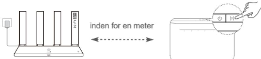
Trin 2: Når indikatoren på HUAWEI CPE begynder at blinke, skal du trykke på H-knappen på den. Vent, til indikatoren på routeren viser, at routeren er tilsluttet netværket.
