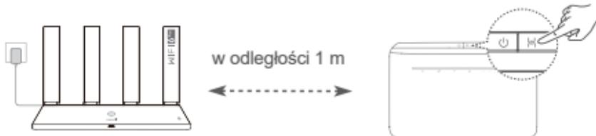
Krok 2: Gdy wskaźnik urządzenia HUAWEI CPE zacznie migać, naciśnij znajdujący się na nim przycisk H. Poczekaj, aż wskaźnik routera zasygnalizuje nawiązanie połączenia z siecią.
