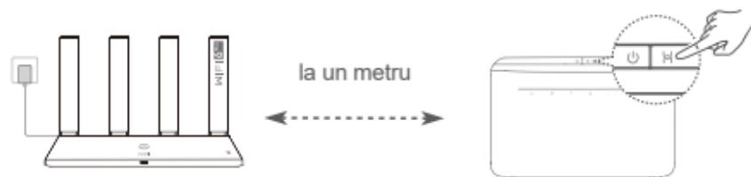
Pasul 2: Când indicatorul de pe HUAWEI CPE începe să lumineze intermitent, apăsați butonul H de pe sistem. Așteptați până când indicatorul de pe router arată că acesta este conectat la rețea.
