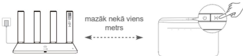
2. darbība: kad sāk mirgot ierīces HUAWEI CPE indikators, nospiediet tās pogu H. Uzgaidiet, līdz indikators uz maršrutētāja norāda, ka maršrutētājā ir izveidots savienojums ar tīklu.
