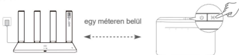
2. lépés: Amikor a HUAWEI CPE készüléken található jelzőfény villogni kezd, nyomja meg rajta a H gombot. Várjon, amíg a router jelzőfénje azt nem jelzi, hogy a router csatlakozik a hálózathoz.
