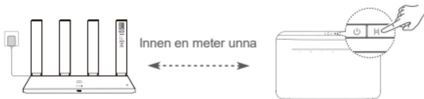
Trinn 2: Trykk på H-knappen når indikatoren på HUAWEI CPE begynner å blinke. Vent til indikatoren på ruteren viser at den er koblet til nettverket.
