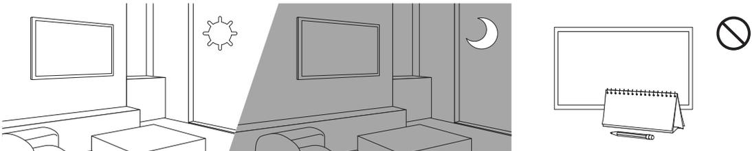
Le capteur Eco ajuste automatiquement la luminosité de l'écran. Il mesure la lumière de votre pièce et optimise automatiquement la luminosité du téléviseur pour réduire la consommation d'énergie. Si vous souhaitez le désactiver, allez à
