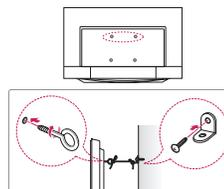
1 Inserire e fissare i bulloni a occhiello o le staffe del televisore e i bulloni sul retro del televisore.
