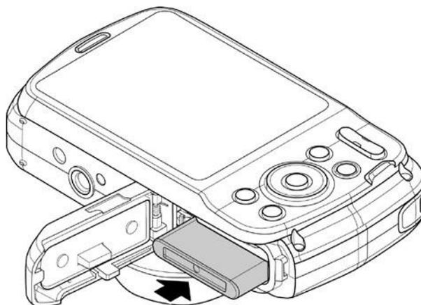
4. Chiudere e bloccare l'alloggiamento della batteria/scheda di memoria per bloccare automaticamente il blocco del coperchio. Per garantire la resistenza all'acqua, scorrere il fermo del coperchio (come illustrato) per bloccare il coperchio della batteria prima di utilizzare in acqua.
