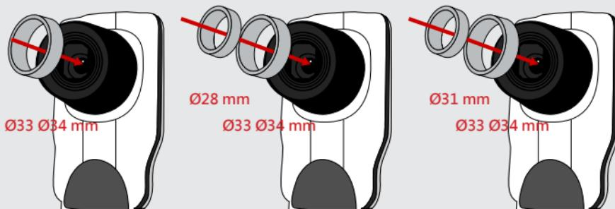
4. Monte el adaptador de microscopio en la lente.
