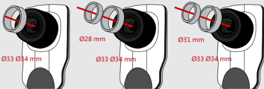
4. Montez / enlevez l'adaptateur du microscope sur / de l'objectif en suivant la manipulation indiquée sur l'image
