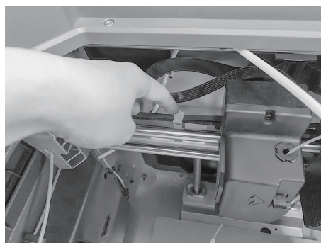
10. 移除X轴同步带和Y轴同步带上的卡扣。
