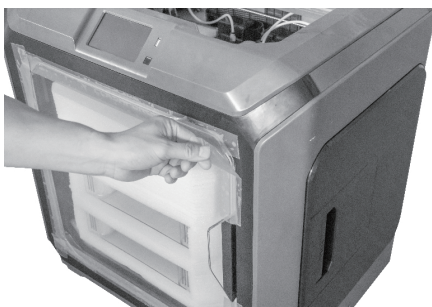
8. 移除固定打印机前门的胶带。
