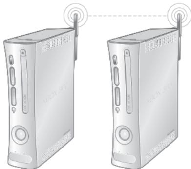
Les réseaux en liaison console sans fil sont également désignés réseaux ad-hoc. Dans ces réseaux ad-hoc, l'adaptateur sans fil d'un périphérique se connecte directement à celui d'un autre périphérique. Aucune connexion Internet n'est partagée avec ce type de réseau. La liaison console est généralement temporaire.
