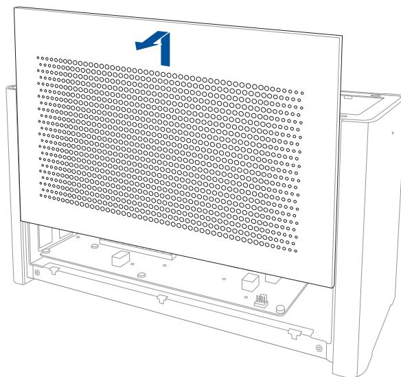
4. Til de handgreep van de luchtfILTER (A) iets op en verschuif dan de luchtfILTER en til deze uit de zijklep (B).
