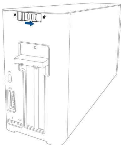
2. トップカバーを製品の後方にスライドさせ、持ち上げて、本体から外します。
