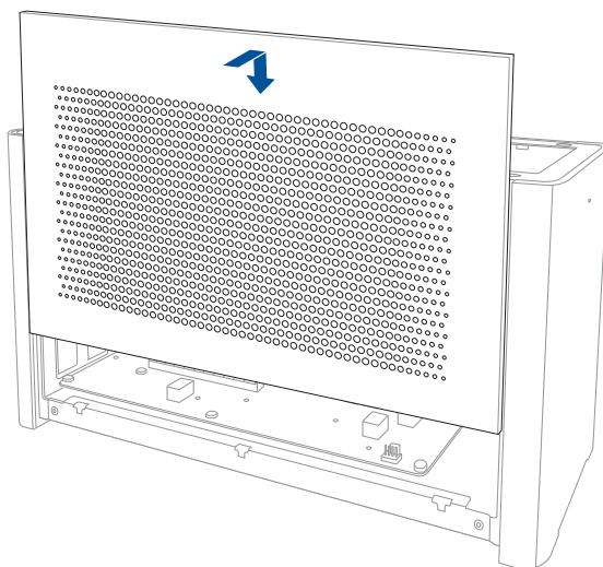
11. Alinee y deslice la cubierta superior hacia la parte delantera de su XG Station PRO para fijarla en su lugar.
