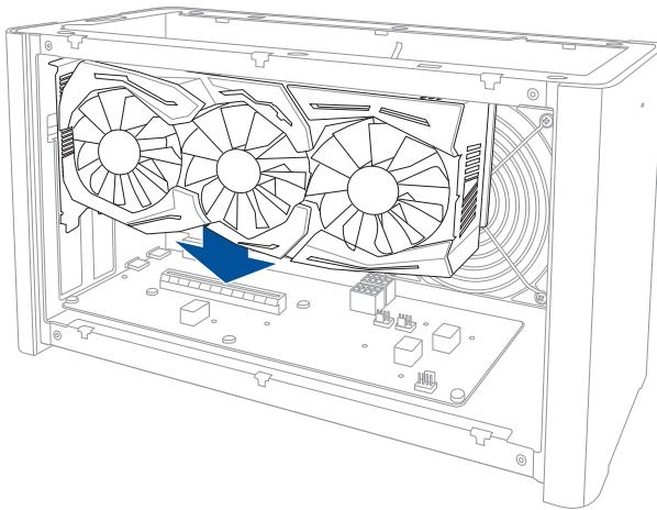
8. Fäst metallfästet med skruvarna du tagit bort tidigare, och anslut nätsladdarna till grafikkortet.
