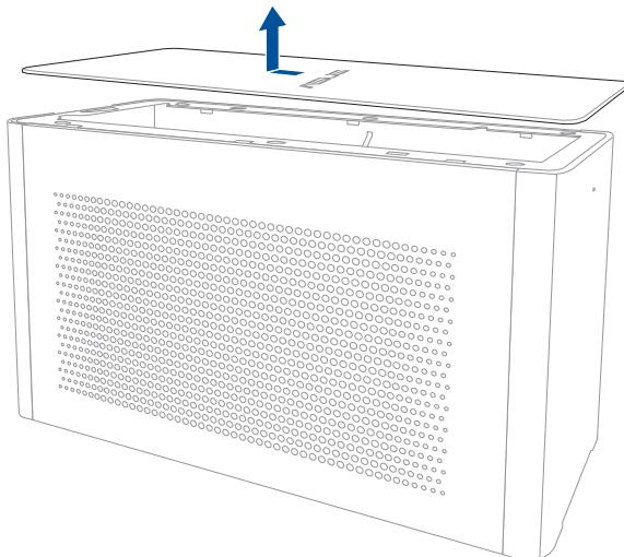
3. Schieben Sie die Seitenabdeckung nach oben und entfernen Sie sie dann von der XG Station PRO.
