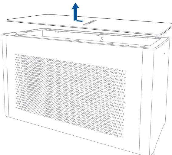
3. Schuif de zijklep omhoog om deze te verwijderen van de XG Station PRO.
