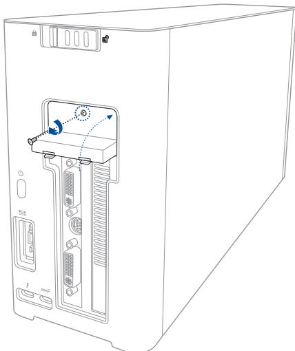
10. Wyrównaj i wsuń pokrywę boczną do urządzenia XG Station PRO.
