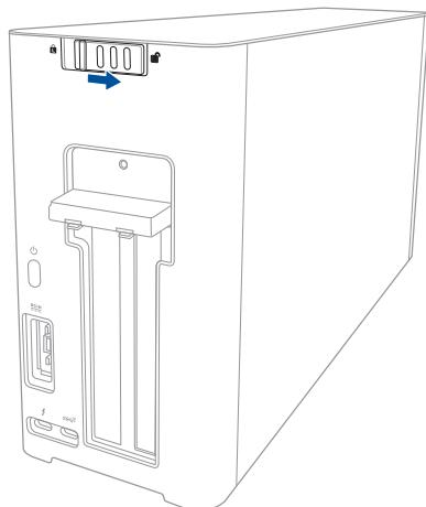
2. トップカバーを製品の後方にスライドさせ、持ち上げて、本体から外します。
