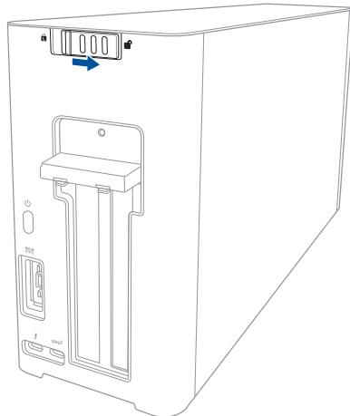
2. Schieben Sie die obere Abdeckung in Richtung der Rückseite der XG Station PRO und heben Sie die Abdeckung dann zum Öffnen an.
