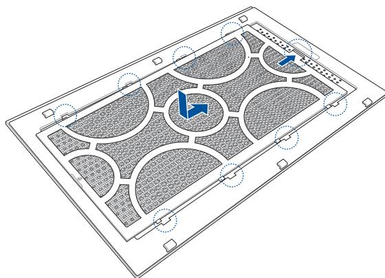
2. Alinee y deslice la cubierta lateral hacia su XG Station PRO.
