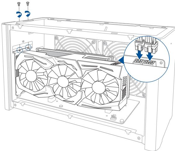
9. Lyft metallsidan uppåt till en stängt läge och fäst med skruven som togs bort tidigare.
