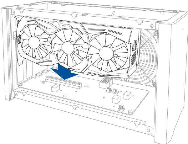
٨. ثبت الكثيفة المعدنية بالبراغي التي قمت بيازتها من قبل، ثم وصل كبلات الطاقة ببطاقة الرسومات.
