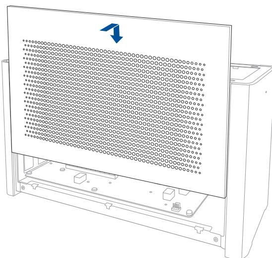
3. Alinhe e deslize a tampa superior em direção à parte frontal da XG Station PRO para a fixar.
