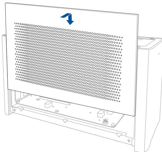
3. Alinee y deslice la cubierta superior hacia la parte delantera de su XG Station PRO para fijarla en su lugar.
