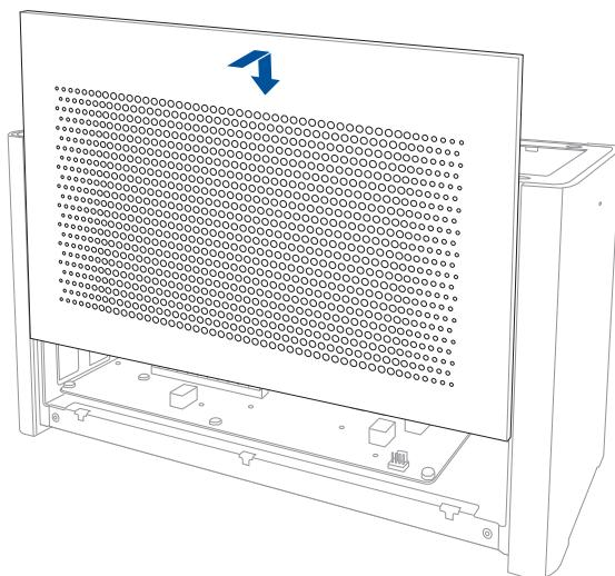
3. Richten Sie die obere Abdeckung an der XG Station PRO aus und schieben Sie sie in Richtung der Vorderseite, bis die Abdeckung fest sitzt.
