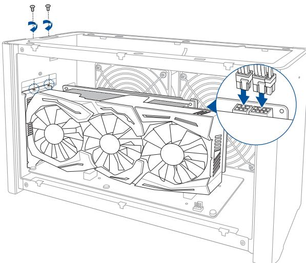
9. 將金屬護蓋向上拉起以合上金屬護蓋，鎖回之前移除的螺絲以固定金屬護蓋。
