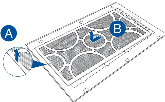
So setzen Sie den Belüftungsfilter wieder ein:
