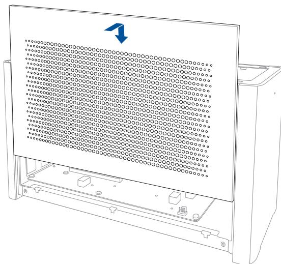
3. Lijn de bovenklep uit en schuif deze naar de voorkant van de XG Station PRO om deze op zijn plaats vast te maken.
