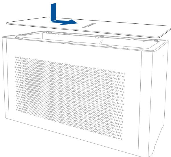
12. Deslice el cierre de la cubierta a la posición de bloqueado.
