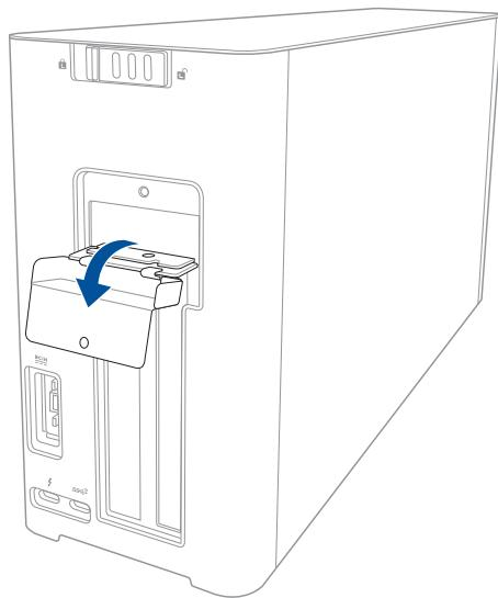
6. Verwijder de schroeven die de metalen beugel vasthouden aan het XG-Station PRO en verwijder dan de metalen beugel.
