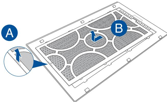
Para volver a instalar el filtro de aire:
