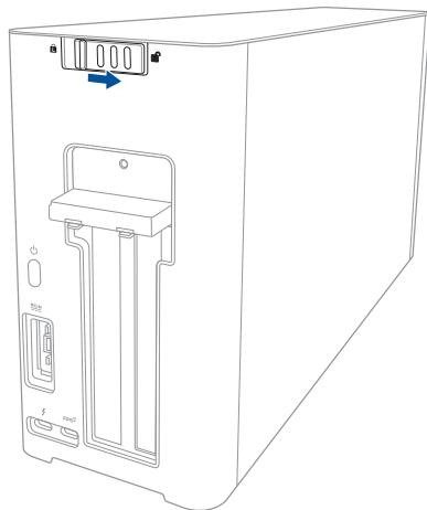
2. Przesuń pokrywę górną w stronę tyłu urządzenia XG Station PRO, a następnie unieś ją w celu zdjęcia.
