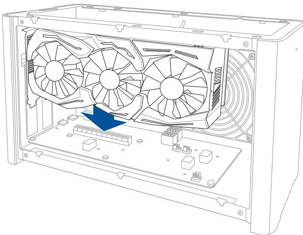
8. 鎖回之前移除的螺絲以固定金屬架，然後將電源線插入顯示卡電源插槽。
