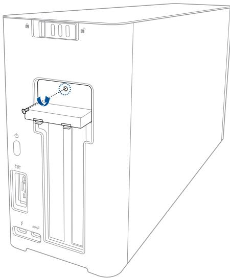
5. Open de metalen klep omlaag naar een geopende positie.
