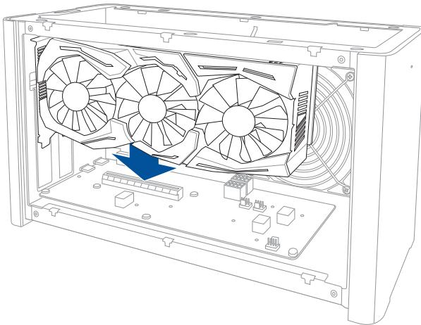
8. 锁回之前移除的螺丝以固定金属架，然后将电源线插入显卡电源插槽。
