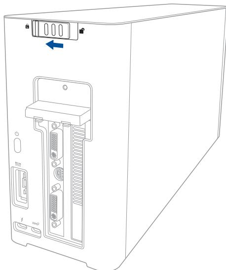
١٣. وصل كبل Thunderbolt™ ٣ من الفئة C المرفق بجهاز الكمبيوتر المحمول وبجهاز XG Station PRO.
