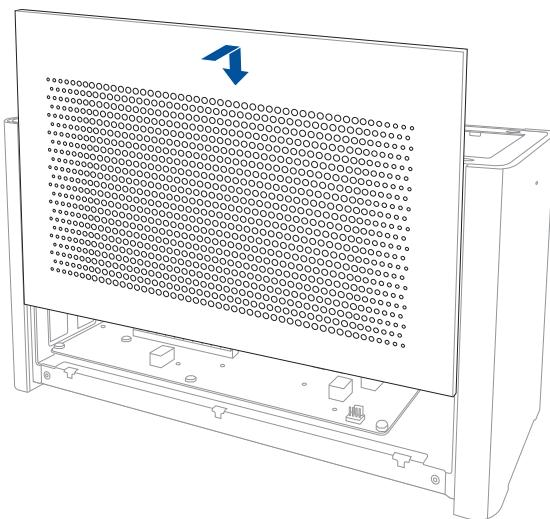
11. Richten Sie die obere Abdeckung an der XG Station PRO aus und schieben Sie sie in Richtung der Vorderseite, bis die Abdeckung fest sitzt.
