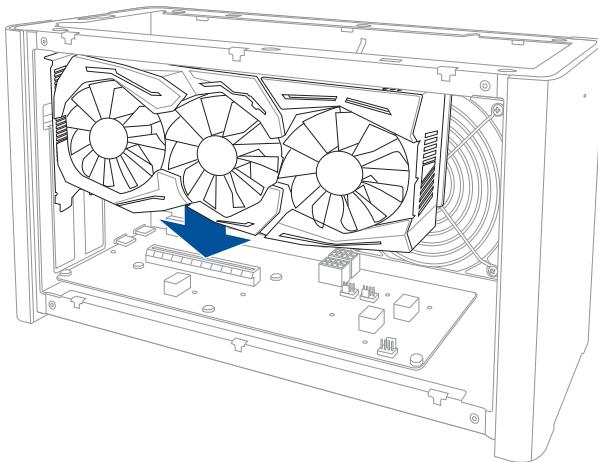
8. Закріпіть металевий кронштейн гвинтами, які ви вийняли раніше, потім підключіть кабелі живлення до відеокарти.
