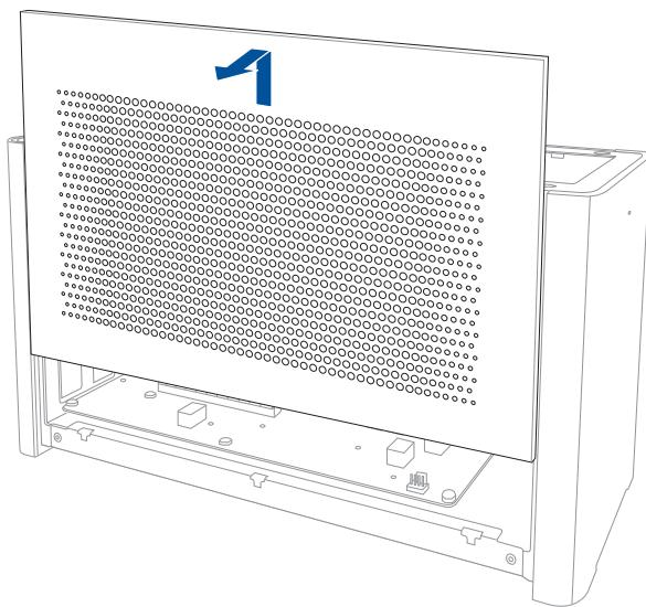
4. Ta bort skruvarna som håller fast metallsidan på XG Station PRO.
