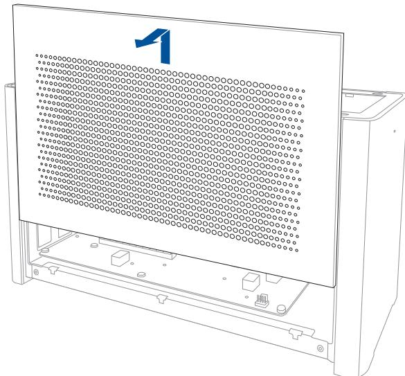
4. Heben Sie den Griff des Belüftungsfilters leicht an (A), schieben Sie den Filter dann und heben Sie ihn aus der Seitenabdeckung heraus (B).
