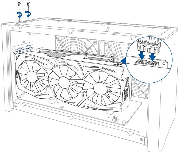
9. Til de metalen klep omhoog naar een gesloten positie en maak de metalen afdekking vast met de schroef die u eerder hebt verwijderd.
