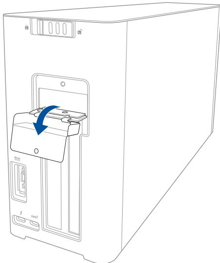
6. 移除固定金屬架與 XG Station PRO 的螺絲，然後移除金屬架。
