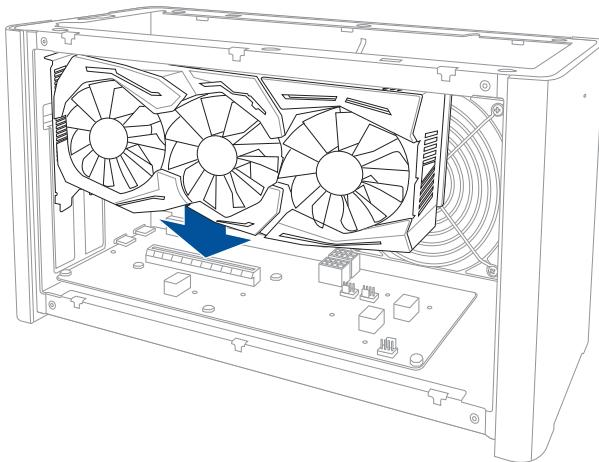
8. Закрепите металлический кронштейн открученными ранее винтами, затем подключите к видеокарте кабели питания.
