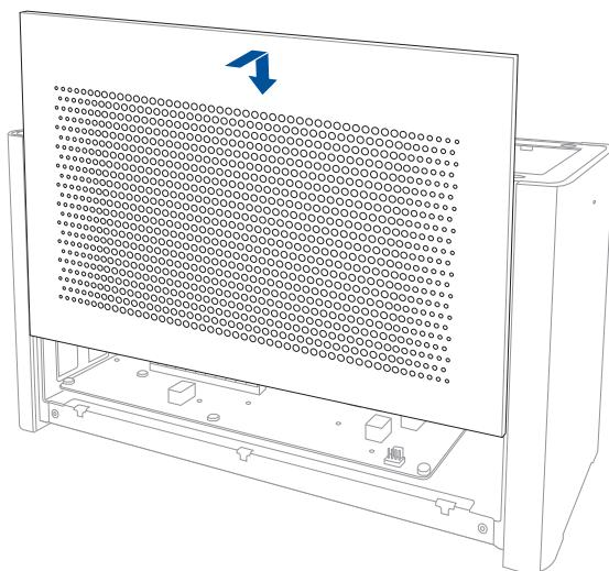
11. Alignez puis faites glisser le couvercle supérieur vers l'avant de la XG Station PRO pour le sécuriser en place.
