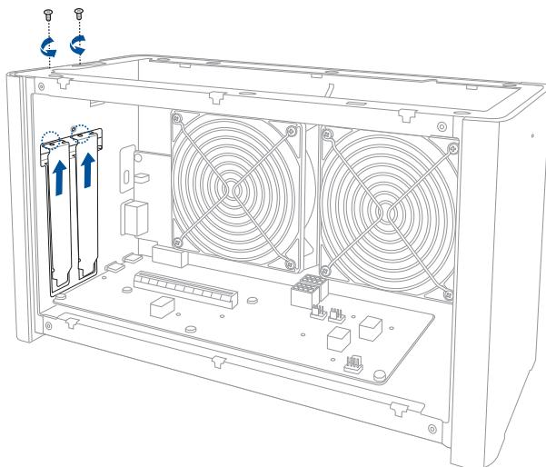
7. Grafickou kartu správně zorientujte a zasuňte do slotu PCI-E.
