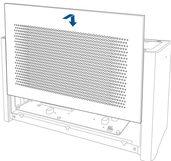
11. Alinhe e deslize a tampa superior em direção à parte frontal da XG Station PRO para a fixar.
