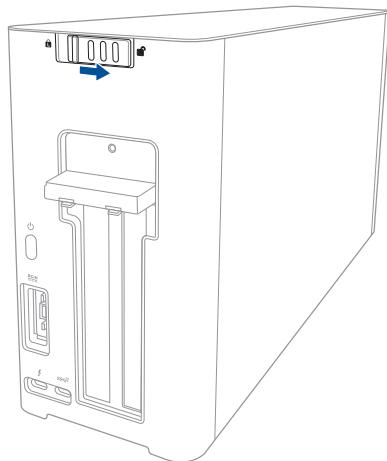
2. Posuňte horní kryt směrem do zadní části XG stanice PRO, poté zvednutím horní kryt otevřete
