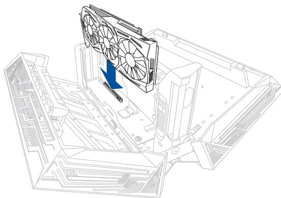
8. Fije el soporte metálico con los tornillos que quitó anteriormente y, a continuación, conecte los cables de alimentación a la tarjeta gráfica.
