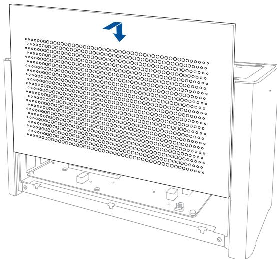
11. Lijn de bovenklep uit en schuif deze naar de voorkant van de XG Station PRO om deze op zijn plaats vast te maken.
