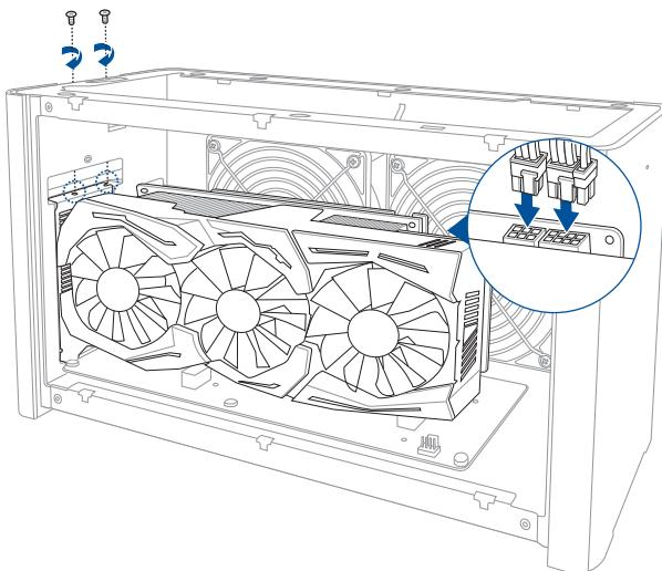
9. Przesuń metalową osłonę do góry do pozycji zamknięcia, a następnie zabezpiecz ją wykręconą wcześniej śrubą.
