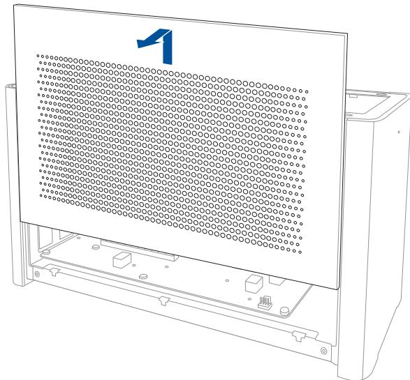
4. 移除固定 XG Station PRO 金屬護蓋的螺絲。
