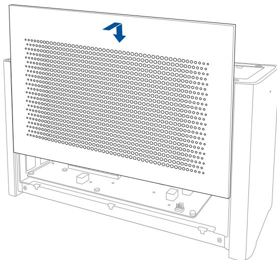
3. トップカバーを製品の後方から前方にスライドさせ、所定の位置に戻します。
