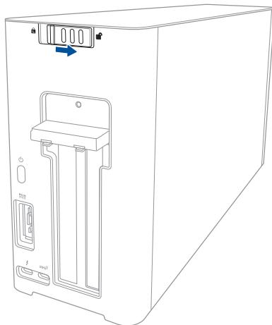
2. Deslize o tampa superior em direção à traseira da XG Station PRO e, em seguida, levante a tampa superior.
