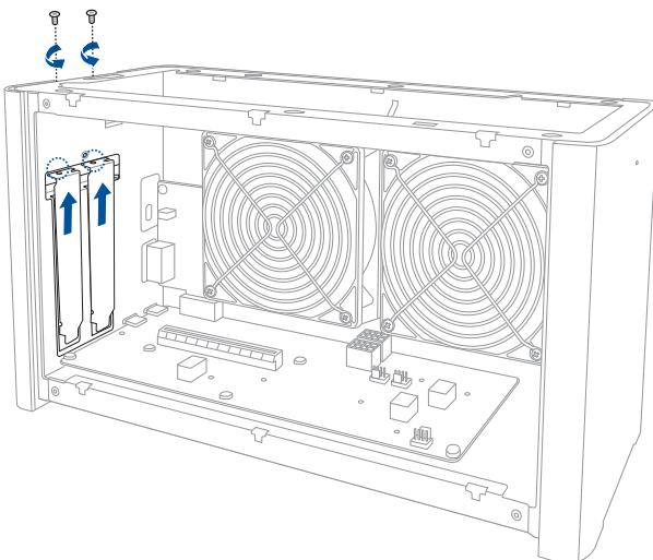
7. 將顯示卡對準並插入 PCI-E 插槽。
