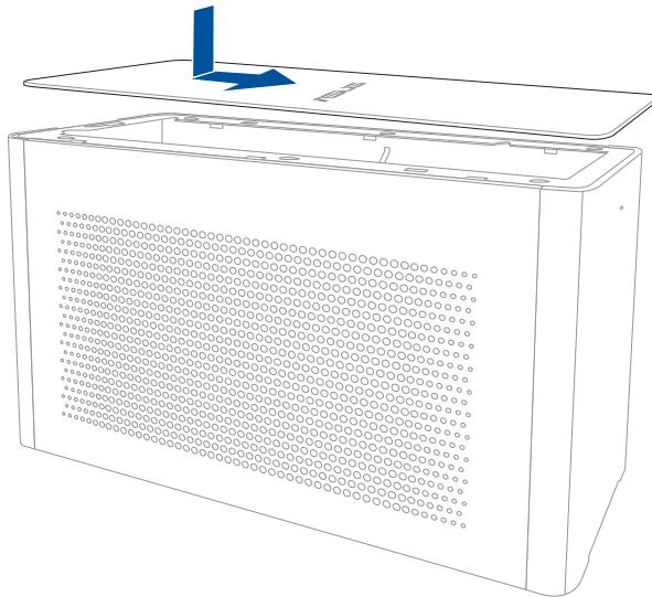
12. Schieben Sie die Verriegelung der Abdeckung in die Sperrposition.
