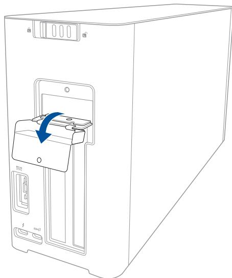
6. Видаліть гвинти, що закріплюють металевий кронштейн на XG-Station Pro, потім зніміть металевий кронштейн.
