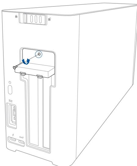
5. Abra la cubierta metálica hacia abajo hasta la posición de abierta.
