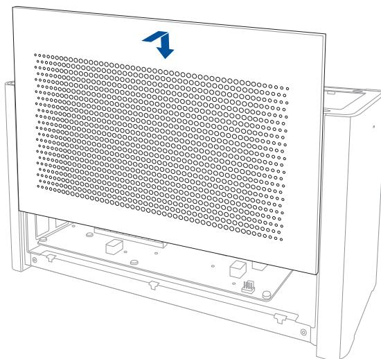
3. Allineate e fate scorrere la cover superiore verso la parte anteriore di XG Station PRO per installarla correttamente.
