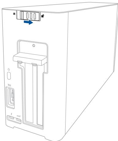
2. Faites glisser le couvercle supérieur vers l'arrière de la XG Station PRO, puis retirez le couvercle supérieur.
