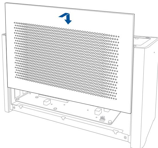
3. Wyrównaj i wsuń pokrywę górną w stronę przodu urządzenia XG Station PRO w celu zabezpieczenia jej na miejscu.
