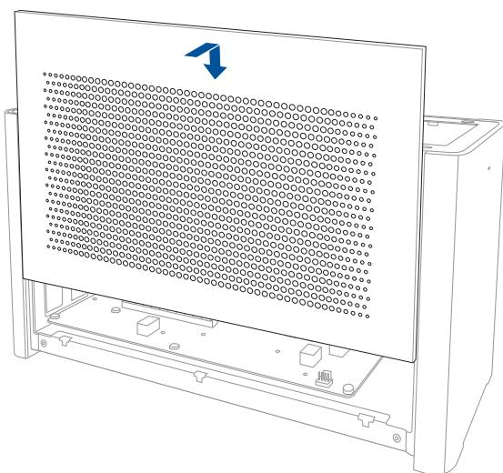
11. トップカバーを製品の後方から前方にスライドさせ、所定の位置に戻します。
