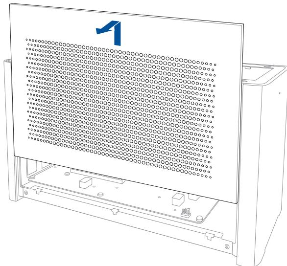
4. 輕輕拉起防塵網卡扣 (A) ，然後推動並拉起防塵網使其與側面板分離 (B) 。
