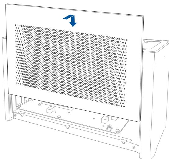
11. Wyrównaj i wsuń pokrywę górną w stronę przodu urządzenia XG Station PRO w celu zabezpieczenia jej na miejscu.
