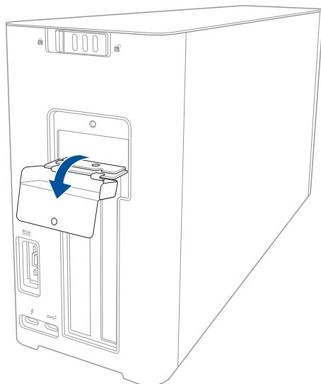
6. 拡張スロット用ブラケットカバーを固定しているネジを外し、ブラケットカバーを取り外します。
