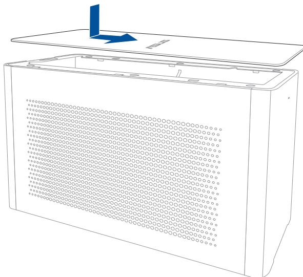
4. Deslice el cierre de la cubierta a la posición de bloqueado.
