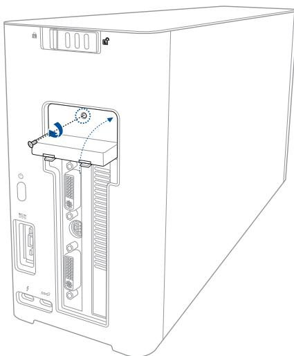
10. Lijn de zijklep uit en schuif deze in de XG Station PRO.
