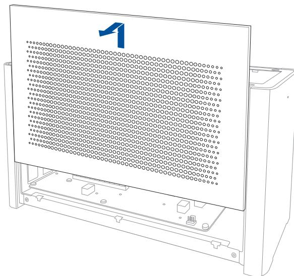
4. Soulevez légèrement la poignée du filtre à air (A), puis faites glisser le filtre à air et retirez-le du couvercle latéral (B).
