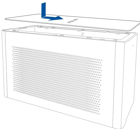
12. Deslize o trinco da tampa para a posição de bloqueio.
