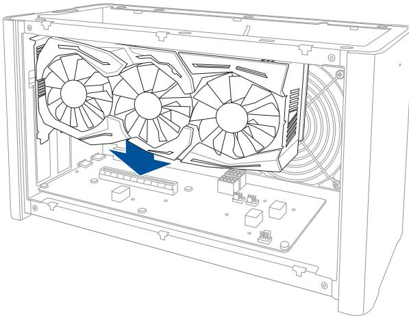
8. Befestigen Sie den Metallbügel mit den zuvor entfernten Schrauben, schließen Sie dann die Stromkabel an die Grafikkarte an.
