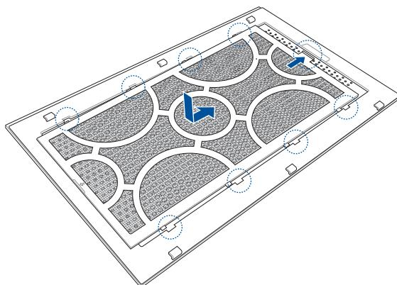
2. Lijn de zijklep uit en schuif deze in de XG Station PRO.
