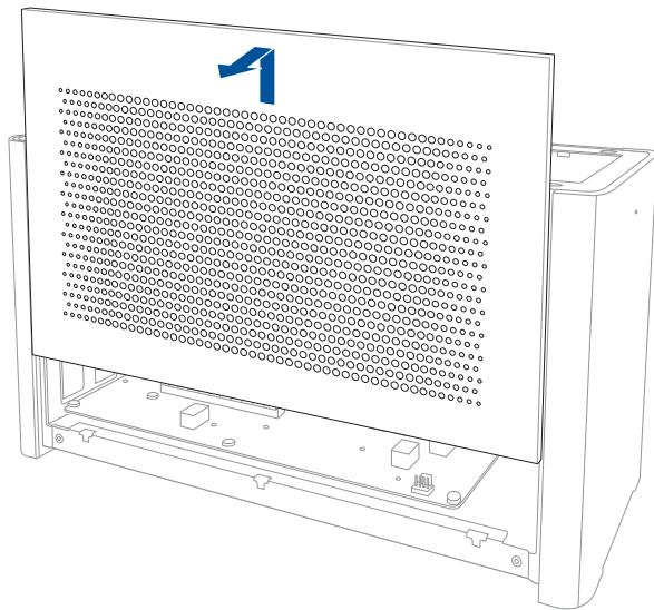
4. 移除固定 XG Station PRO 金属护盖的螺丝。
