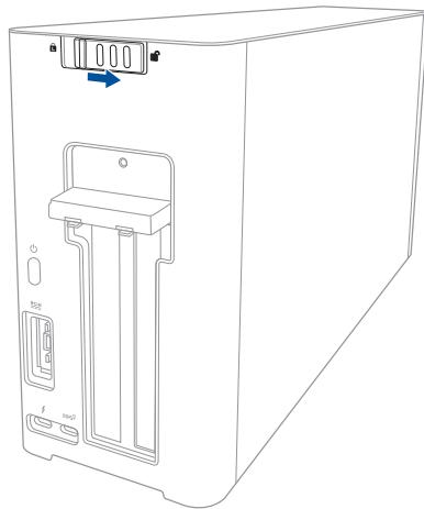
2. Schuif de bovenklep naar de achterkant van de XG Station PRO en til dan de bovenklep op om deze te openen.
