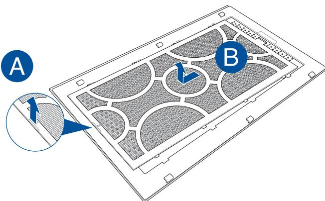
Per reinstallare il filtro dell'aria:
