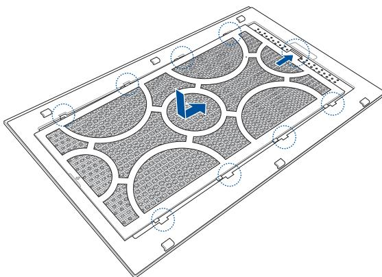
2. Wyrównaj i wsuń pokrywę boczną do urządzenia XG Station PRO.
