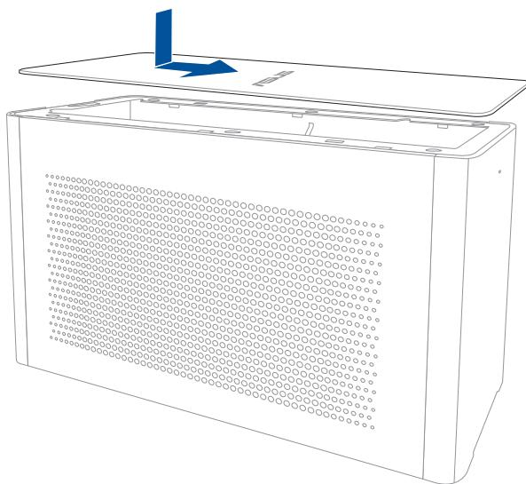
4. Deslize o trinco da tampa para a posição de bloqueio.
