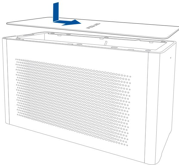
4. Schieben Sie die Verriegelung der Abdeckung in die Sperrposition.
