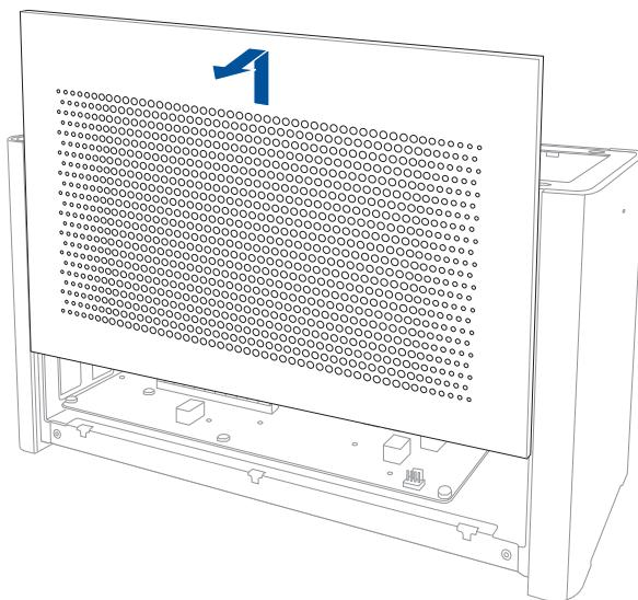
4. Rimuovete le viti che fissano la cover metallica a XG Station PRO.
