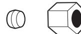
Écrou à compression d'un diamètre extérieur de 1/4 po et bague (modèles avec machine à glaçons seulement)
