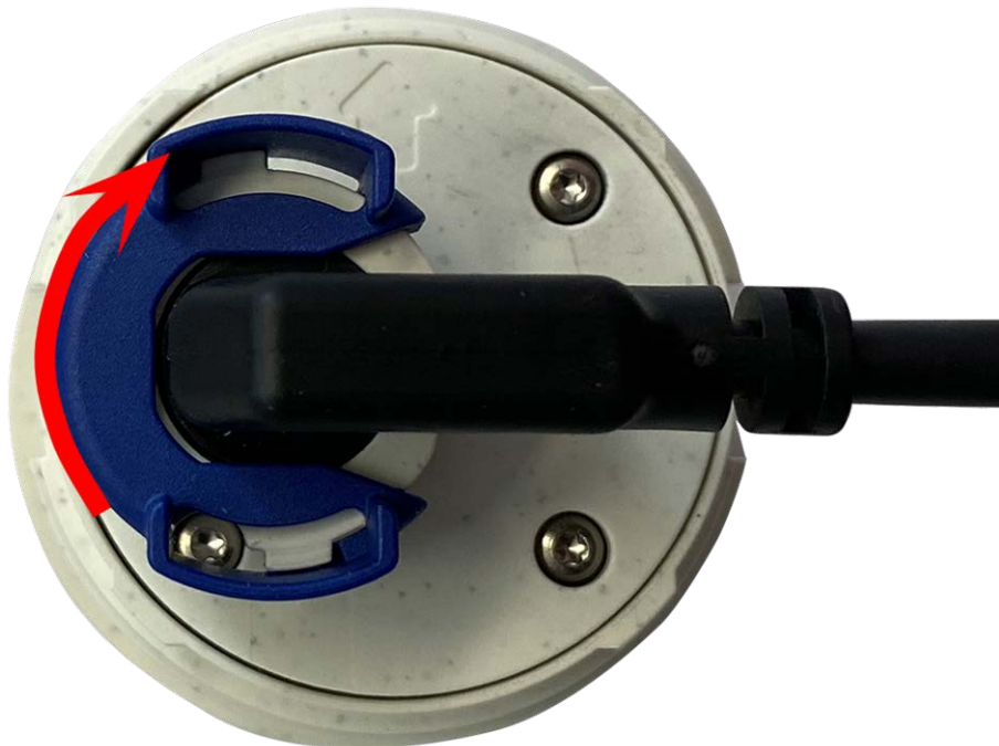
Fig. 28: Lock sensor module cable
