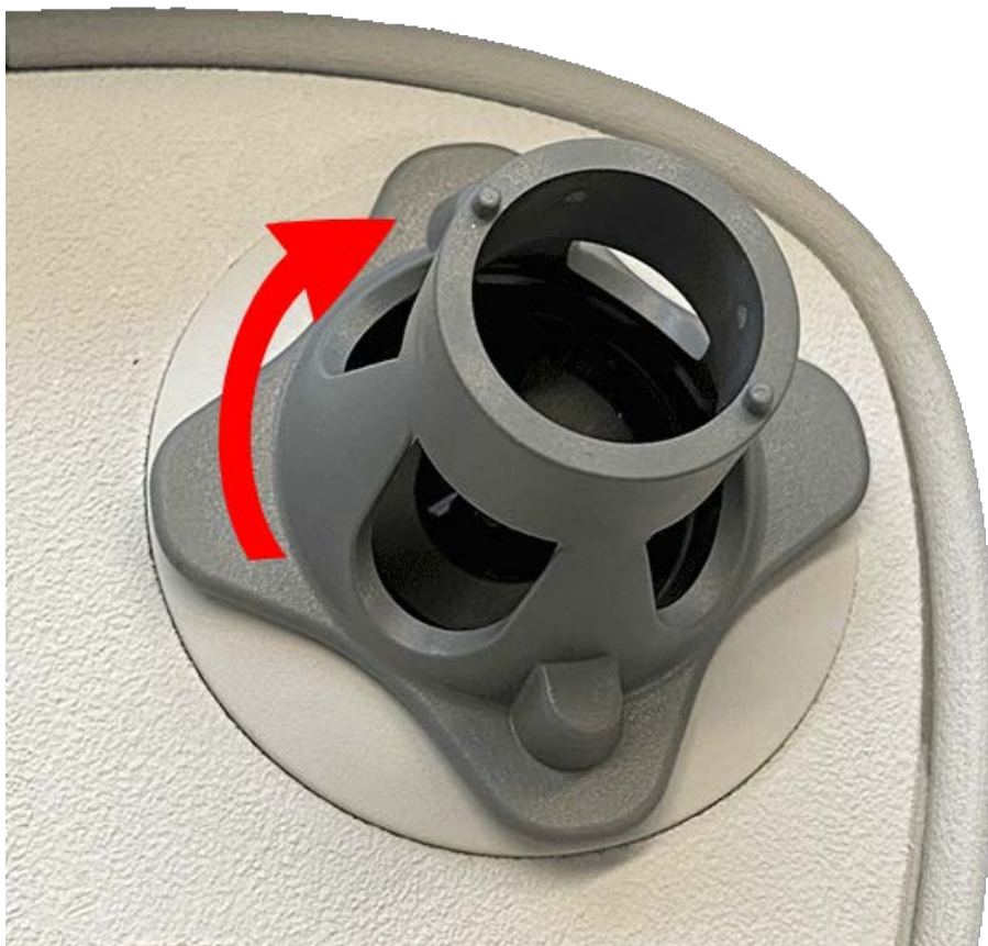
Fig. 26: Lock the sensor module
