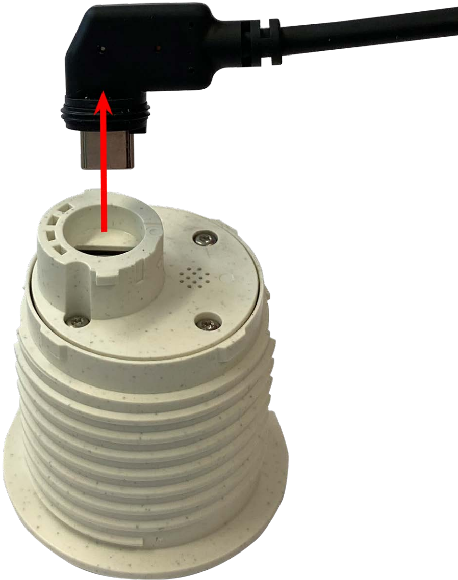
Fig. 21: Remove the sensor module cable
