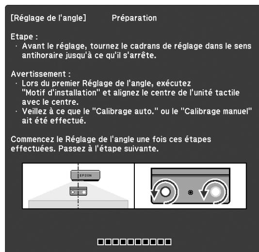
6. Tournez les cadrans de réglage de l'unité tactile dans le sens inverse des aiguilles d'une montre jusqu'à ce que vous entendiez un clic. Puis, appuyez sur le bouton ↶ de la télécommande.
