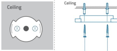
4. Lijn de groeven uit met de montageplaat en draai de Indoor Cam met de klok mee totdat deze op zijn plaats klikt.
