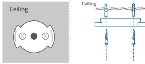
4. Alignez les rainures avec la plaque de fixation et faites pivoter la caméra intérieure eufy, jusqu'à ce qu'elle se clipse.
