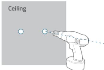
3. Allineare i fori sulla piastra di montaggio con quelli sul soffitto. Inserire i tasselli all'interno dei fori, necessari nei casi in cui le pareti siano in materiali duri come calcestruzzo, mattoni o stucco. Fissare le viti con un cacciavite a stella per fissare la piastra di montaggio al soffitto.
