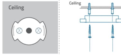
4. 本体底面の溝を取り付けプレートに合わせ、カチッと所定の位置に収まるまでカメラを時計回りに回転させてください。
