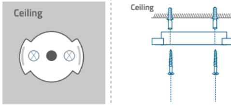
4. Alinee las ranuras de la placa de montaje y gire la cámara de interior eufy en sentido de las agujas del reloj hasta que encaje en su lugar.
