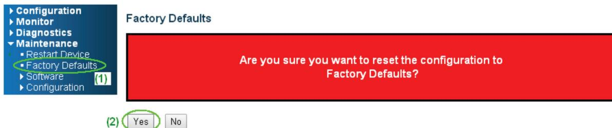
FIGURE 3-19. RESET TO FACTORY DEFAULTS SCREEN
