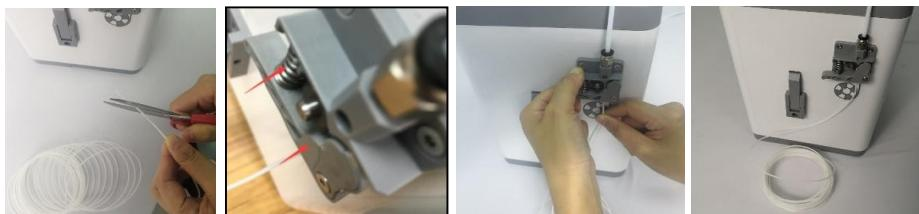
Druk op de knop om te beginnen met het laden van filament. Zodra het filament uit de nozzle begint te extruderen, drukt u nogmaals op de knop om extrusie te stoppen en vervolgens op de knop om de optie Hervat print te selecteren.
