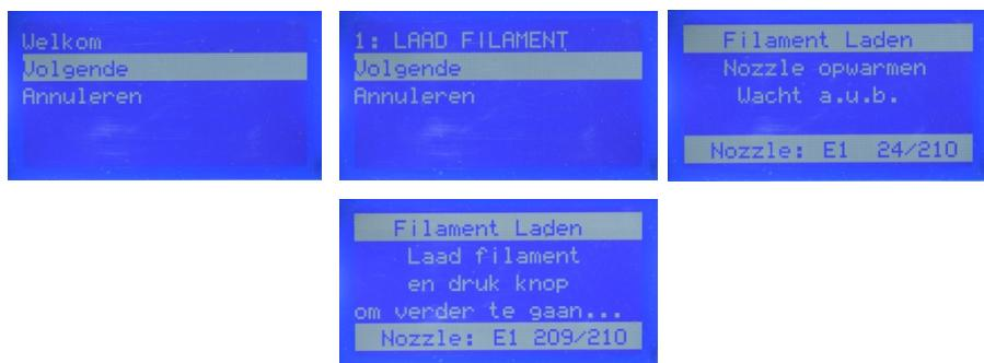
Knip met een schaar of zijkniptang ongeveer 2,5 cm van het uiteinde van het filament af en strijk het uiteinde van het filament voorzichtig recht. Knip in de hendel van de extruder, steek het filament in de bodem totdat u weerstand voelt en laat de hendel vervolgens los.
