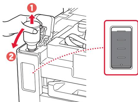
7 Vuelva a colocar la tapa del depósito firmemente.
