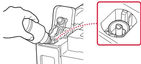
5 Coloque lentamente el frasco de tinta boca abajo y empuje hacia abajo para verter la tinta.
