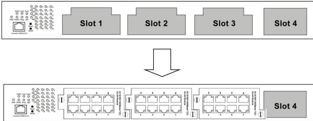
Figure 3-3. RJ-45 module.
