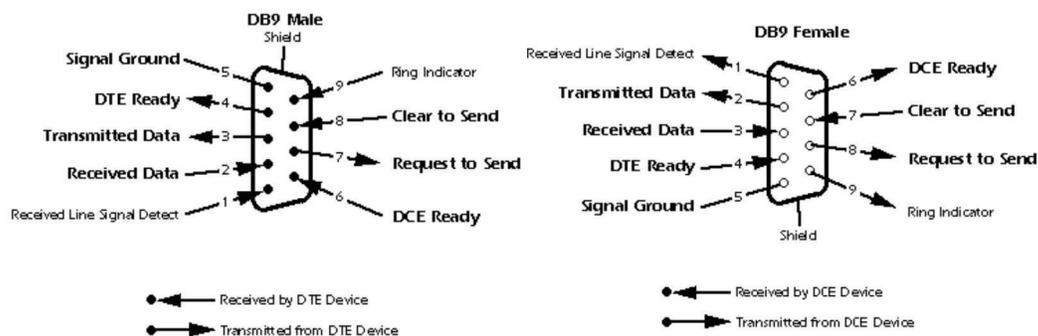
Figure 3-8. RS-232 port wiring diagram.
